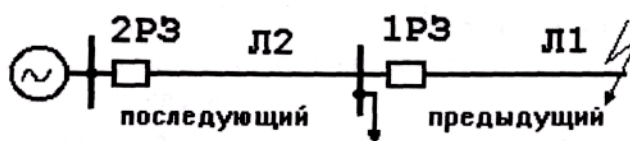
Рисунок 10.1 – Расчётная схема для выбора уставок релейной защиты (РЗ)
