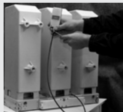
Рис. 50. Регулировка положение индикатора в окошке
